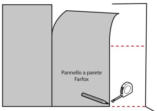
Rileva la distanza tra l'ultimo telo e angolo muro, rileva la misura in parecchi punti, perché i muri non sono mai troppo regolari.
